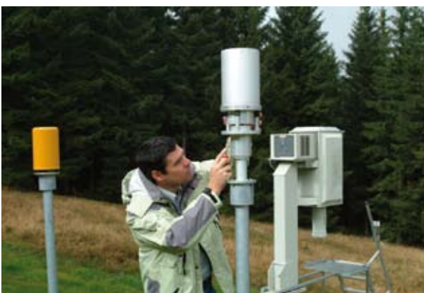
Die äußere Strahlenbelastung lässt sich durch Sonden messen, hier auf dem Schauinsland bei Freiburg
