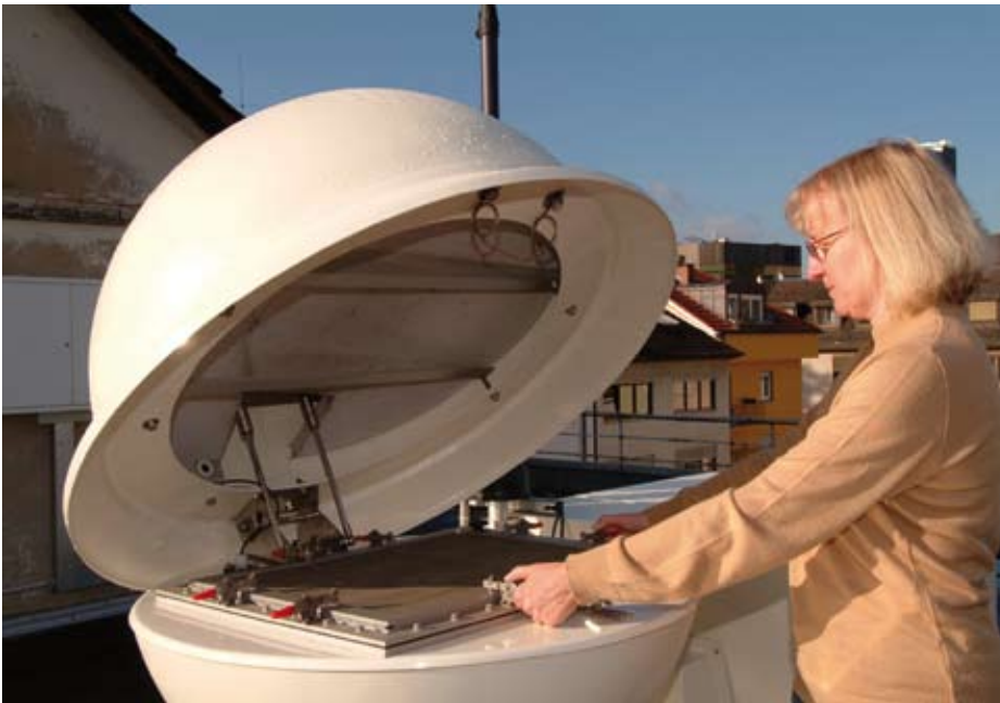
Vorsorge im Strahlenschutz: Der Hochvolumensammler für Luftstaubproben weist selbst geringste Spuren radioaktiver Stoffe in der Luft nach
