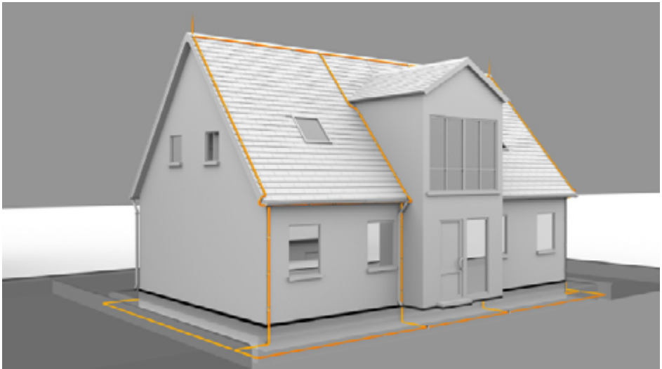
Äußere Blitzschutzanlage an einem Haus.
