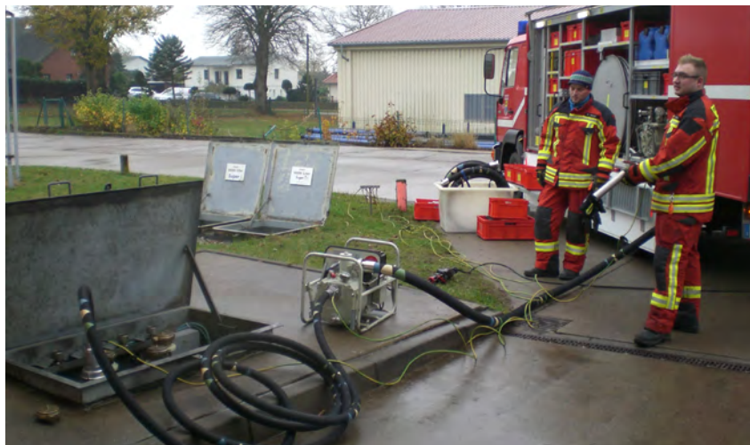
Abbildung 24 Erdung der Anlage (Quelle: M. Tessin).
