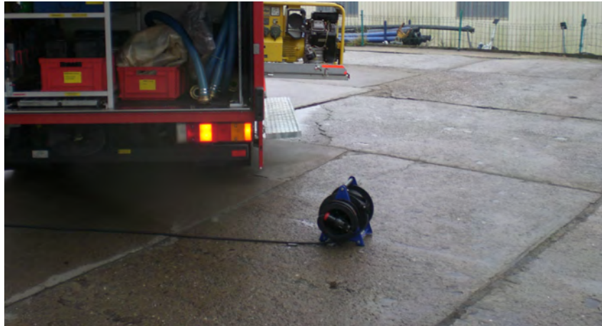
Abbildung 20 Kabeltrommel 400V 50m Länge (Quelle: M. Tessin).
