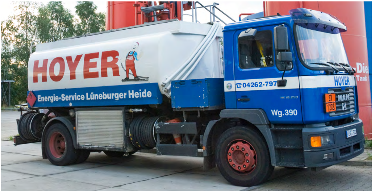
Abbildung 4 Tankwagen zur Versorgung von Notstromaggregaten. (Quelle: Wilhelm Hoyer GmbH & Co.KG).
